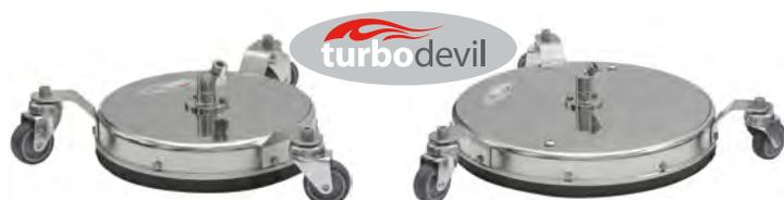
Surface cleaner con giunto girevole di nuova concezione per alti giri al minuto. La curvatura della parte girevole è regolabile rendendo così possibile una facile pulizia di pavimenti e pareti. 3 ruote (60 mm). Sono necessari 2 ugelli 1/4" M.
