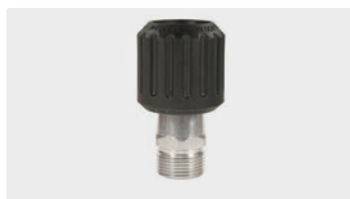
M22 F : M22 M. Stainless steel. Max. 400 bar / 150 °C
